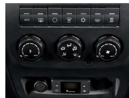
Блок управления системой кондиционирования и отопления
